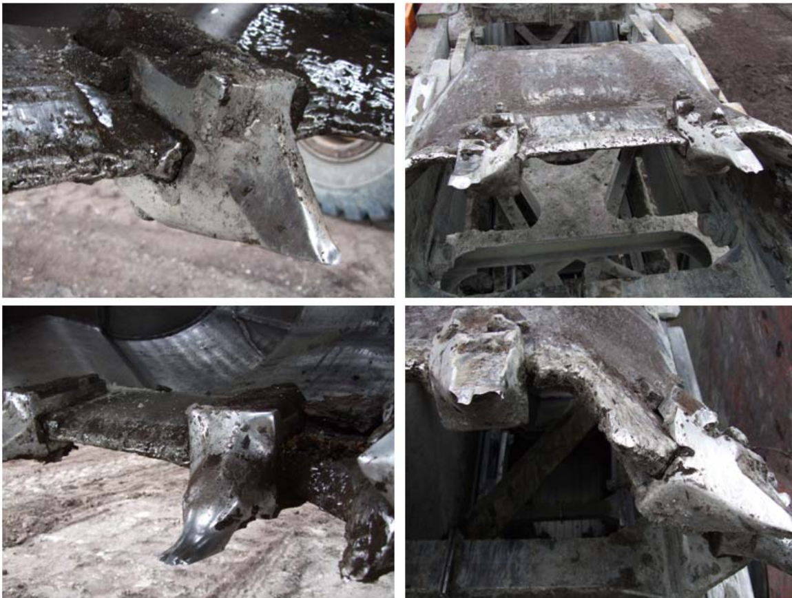
Слика 2. Хабање ведрице са постојећим резним зубима на багеру ведричару ЕРС1000
