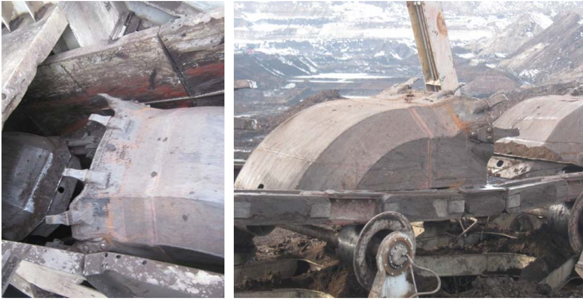
Слика 18. Индустрijски прототип ведрице монтиран на багер и тестирање у експлоатационим условима
