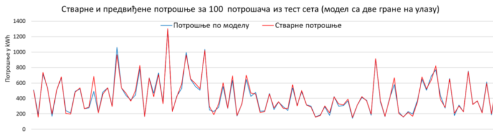
Слика 6-7: Дијаграм стварних и вредности по моделу (модел са паралелним слојевима, две гране и два улаза) – за 100 потрошача из скупа насумично одабраних
