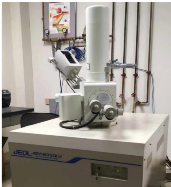
Слика 3-5. Уређај за скенирајућу електронску микроскопију JEOL JSM-6390 LV.
